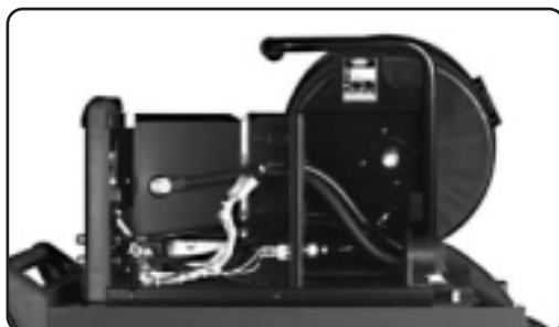
obr. 24 Montáž spojovacího hadicového vedení na podavač drátu VR 3000
