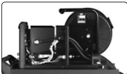
obr. 24 Montáž spojovacieho hadicového vedenia a podávača drôtu VR 3000
