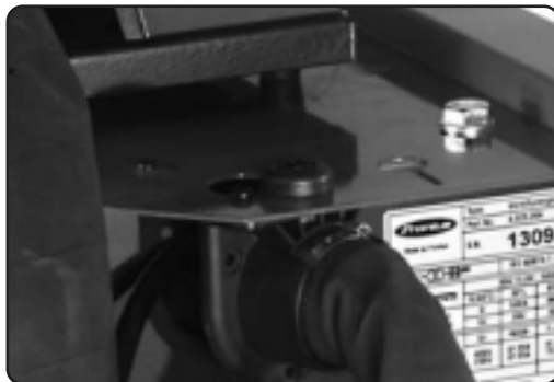
obr. 22 Montáž spojovacího hadicového vedení na zdroj
